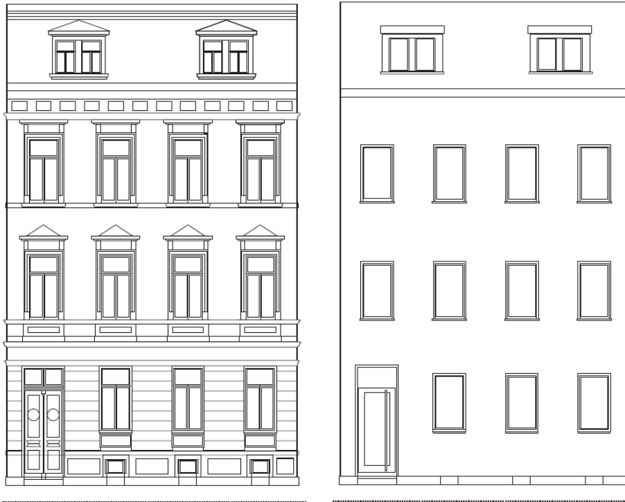
Abbildung 11: Gründerzeitfassade vor und nach der Sanierung bei Verwendung von Standardprodukten
